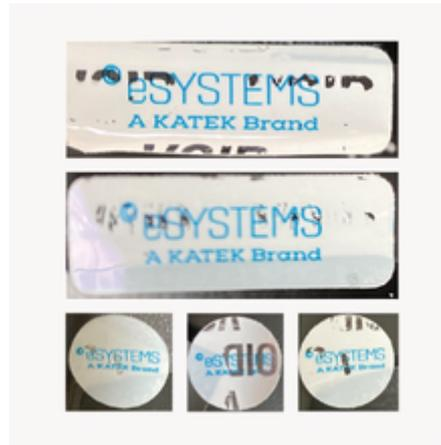
Abb. 10: Beispiel für beschädigte Siegel
